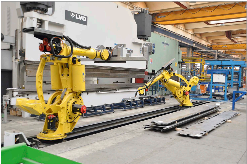
A gémek profilját kialakító robotizált automata hajlítóberendezés
