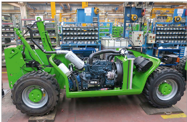
A szerelősoron az alváz már beépített motorral
