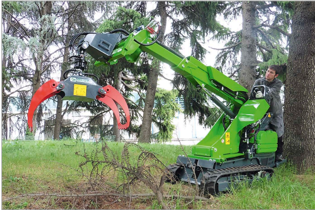
Cingo M12.3Plus + Handler 400 teleszkópos gém forgó farönkfogóval
