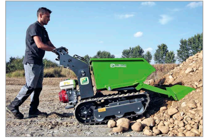
Cingo M500DP billenthető puttonnyal és önrakodó kanállal
