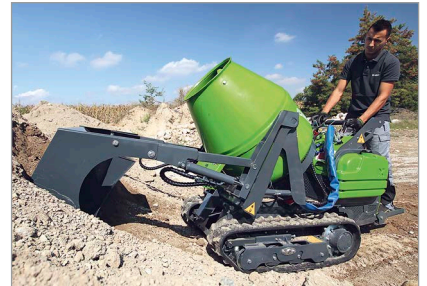
Cingo M8.3Plus betonkeverővel és önrakodó kanállal
